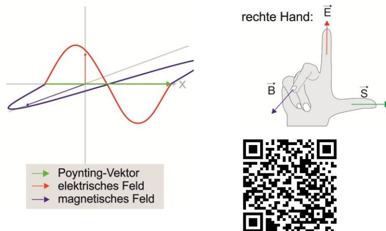
Abbildung 1: Elektromagnetische Welle und rechte Hand Regel
